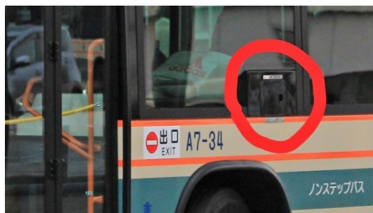
(図4. 拡大図 丸で囲った部分が給油口) 左側に給油口がある車両は狭山、新座、川越(一部)、大宮(一部)に配置されています。
